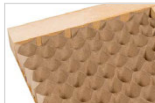
Sać meda i ispuna pločom SAMO za vrata od ploča. Za punu ploču koristimo obvezno dodatnu treću šarku.
